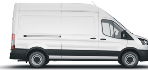
L3H3 Furgão com capacidade volumétrica de carga de 12,4m³ e categoria "B" de habilitação.
